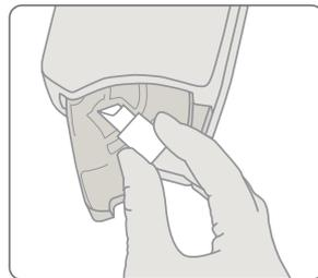
**2** Legen Sie die Mikroküvette in den Analyzer ein.
